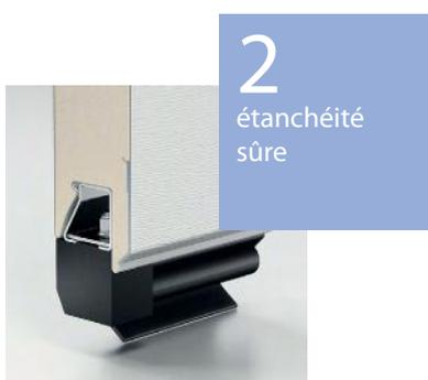
Afin d'assurer une meilleure étanchéité à l'air et à l'eau, le tablier de portes est équipé de joints EPDM périphériques. Un joint multitubulaire protège ainsi les locaux contre les intempéries au niveau du sol. Les butées plastiques protègent le joint d'étanchéité inférieur contre la surcompression et servent à prévenir l'endommagement des optopalpeurs.
