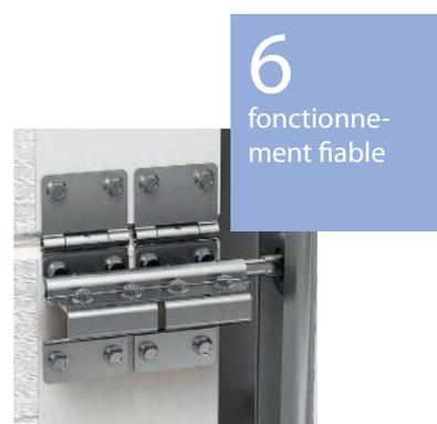
Le tablier de portes plus de 5 m de largeur reçoit deux supports de galet en tandem et en plus chaque panneau est doté d'un raidisseur longitudinal pour une meilleure rigidité. S'agissant d'un tablier pesant, les portes de structure renforcée présentent la solution la plus appropriée pour usage intensif et sont livrables sans surcoût.
