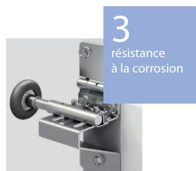
Les supports de galets et les charnières intermédiaires sont fabriqués en acier inoxydable et donc possèdent d'excellentes propriétés anticorrosion. Grâce au revêtement multicouche de panneaux ainsi qu'aux plaques latérales de renfort laquées, le tablier de portes ALUTECH résiste au « brouillard salin » pendant 750 heures ce qui équivaut à 15 ans d'utilisation dans les régions côtières et zones industrielles.
