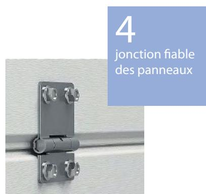
Les charnières intermédiaires en forme de « tôle pliée » pour une meilleure résistance à l'arrachement garantissent une articulation fiable des panneaux. Les essais ont confirmé qu'une charnière résiste à une force de traction équivalente à 7 kN soit 715 kg. Ceci permet d'exclure tout gauchissement.
